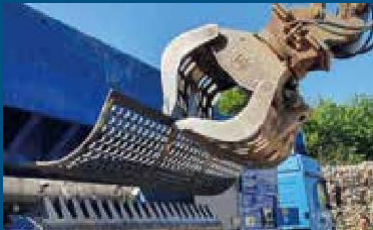
TEUTON: Sistem de coșul de sită - pentru producția de granule finite
