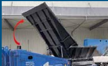
Buncăr automat (FORUS) - pentru optimizarea automată a alimentării
