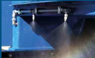
Dispozitiv de umezire a materialului - pentru reținerea prafului
