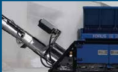
Separator magnetic de neodim reglabil hidraulic pe înălțime
