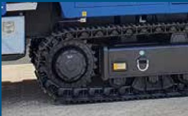
Acționări pe șenile robuste, 2 viteze, plăci de protecție la sol
