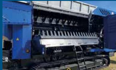
Trapă de tocare - pivotabilă hidraulic = acces liber la zonă de tocare
