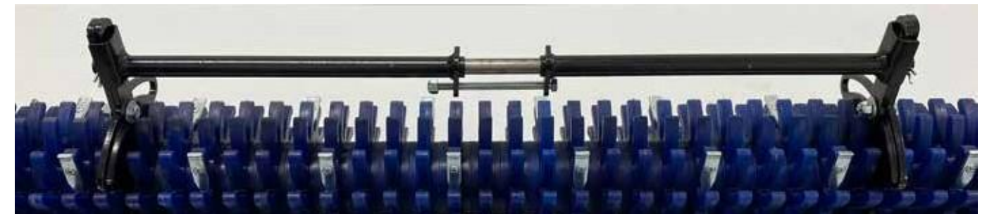
Arbore de sită fină Eggersmann cu sistem QuickChange
