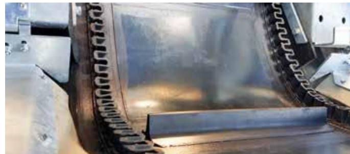
Bandă dintr-o singură bucată pentru granulație fină
