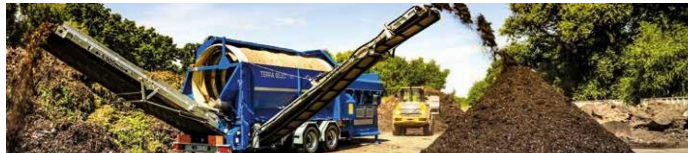
Bandă extinsă pentru granulație fină
