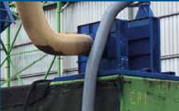
AIRFIX - Separator cu aer pentru folii și materiale ușoare
