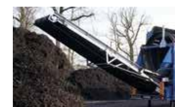
Bandă cu granulație grosieră extinsă, înălțime de descărcare de până la 3.800 mm
