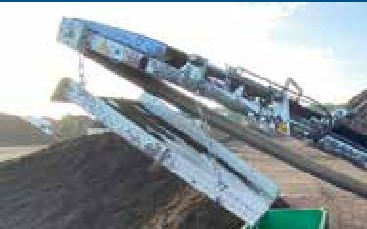
Cilindri magnetici - pentru separarea fierului pe banda de descărcare
