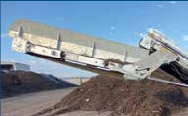
Bandă pentru piatră - pentru separarea pietrelor și a impurităților grele
