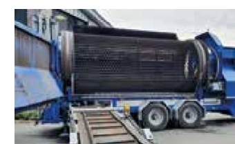
Schimbare ușoară a tamburului cu diametre de până la 2.000 mm
