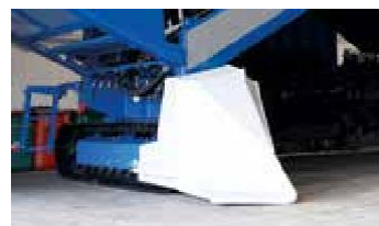
Curățitor depozit de deșeuri
